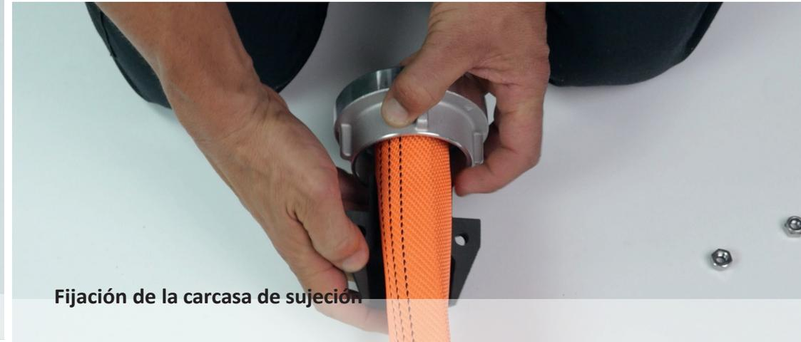
Fijación de la carcassa de sujeción
